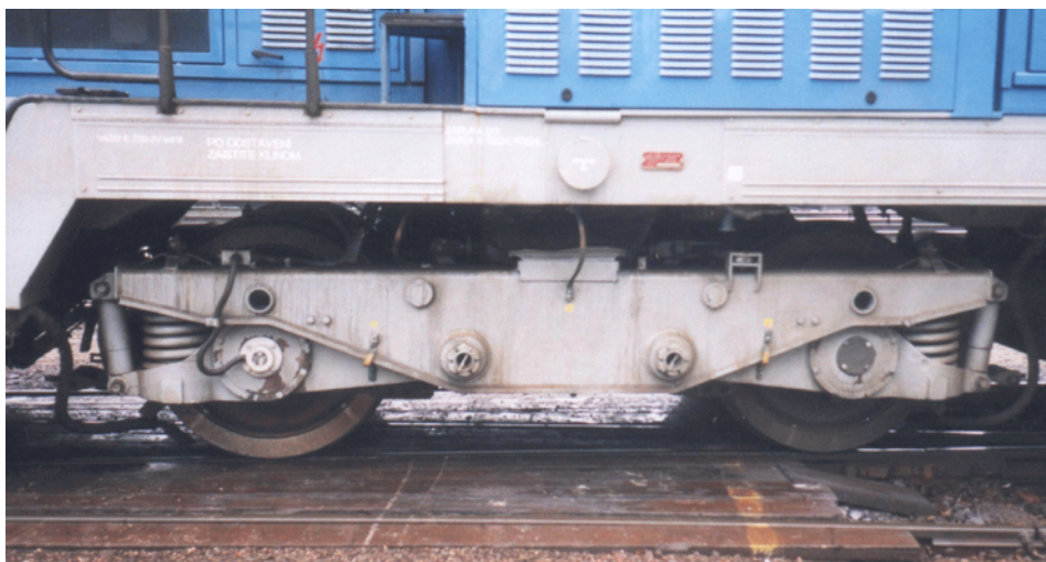
VEDENIE NÁPRAVOVÝCH LOŽÍSK KÝVAČKAMI (R. 736)
