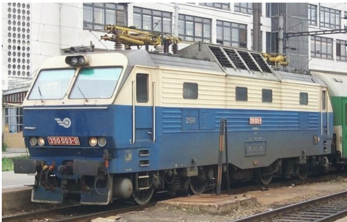
DVOJSYSTÉMOVÝ ELEKTRICKÝ RUŠEŇ R. 350, 4000 kW (ŠKODA Plzeň, n.p.)
