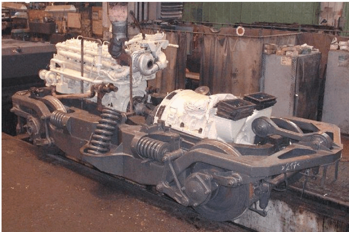
ULOŽENIE HNACIEHO AGREGÁTU V PODVOZKU MOTOROVÉHO VOZŇA R. 830
