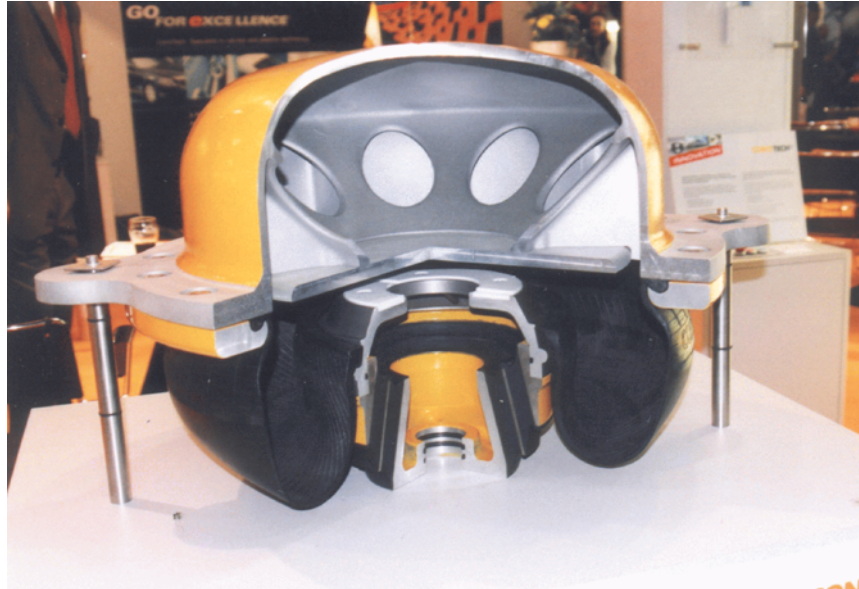
PNEUMATICKÁ PRUŽINA SO VSTAVANÝM PRÍDAVNÝM VZDUCHOJEMOM
