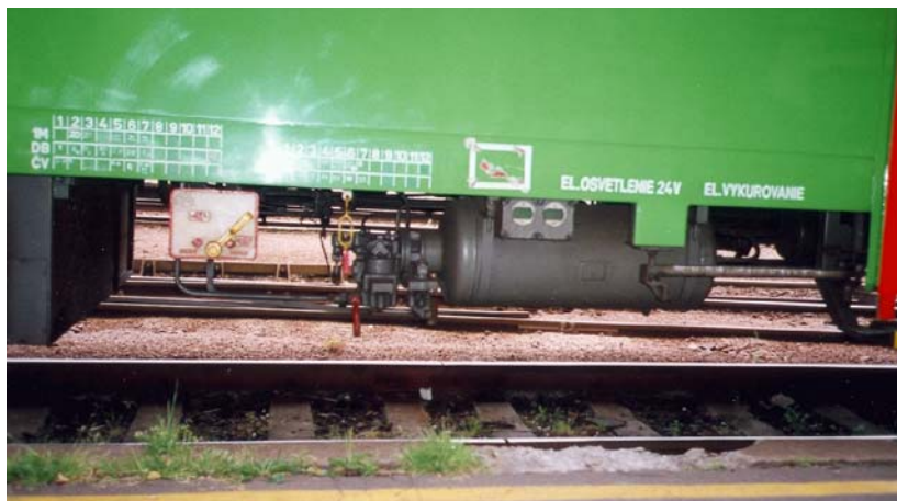
POMOCNÝ VZDUCHOJEM A ROZVÁDZAČ
