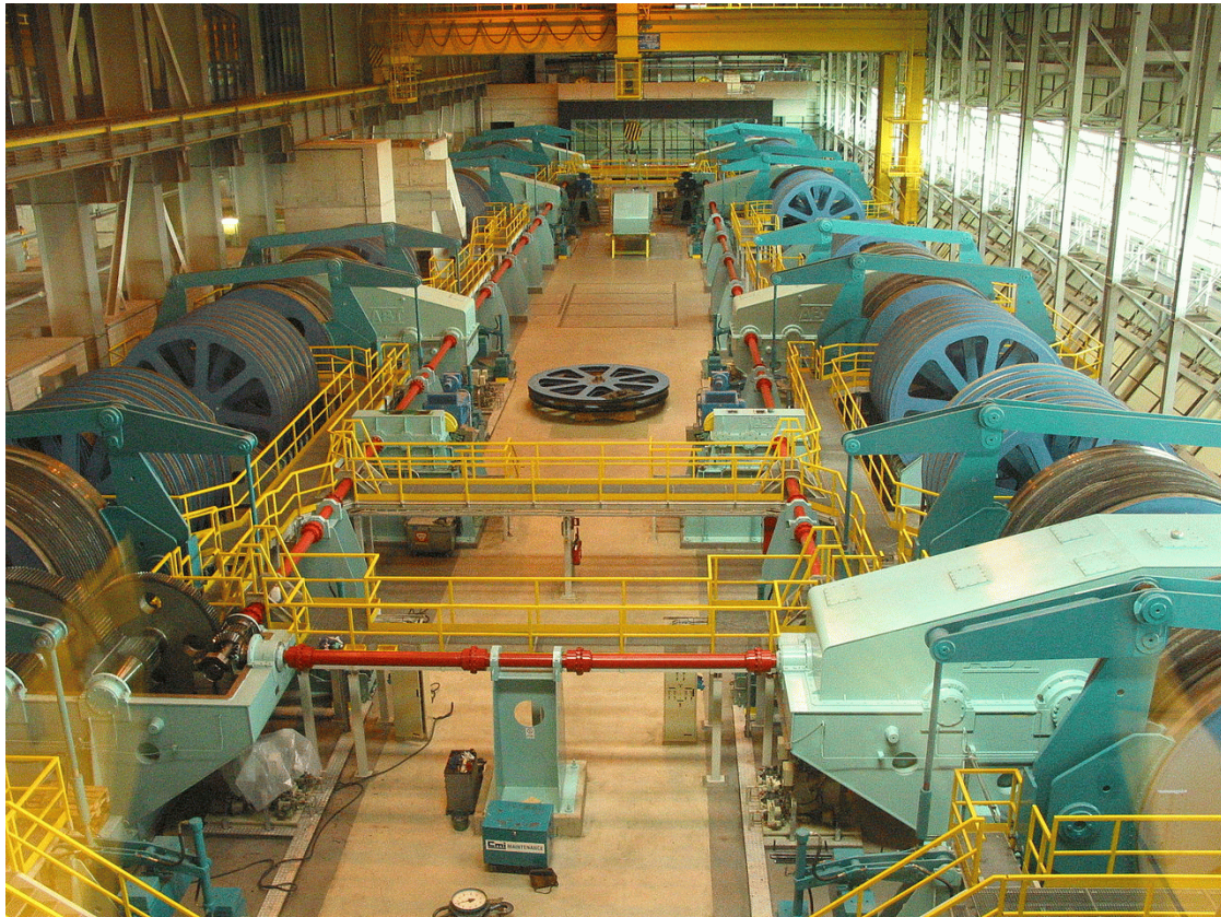
STROJOVNĀ DVOJITÉHO LODNÉHO ZDVÍHADLA S PROTIZÁVAŽIAMI (Strépy-Thieu, Francúzsko)
