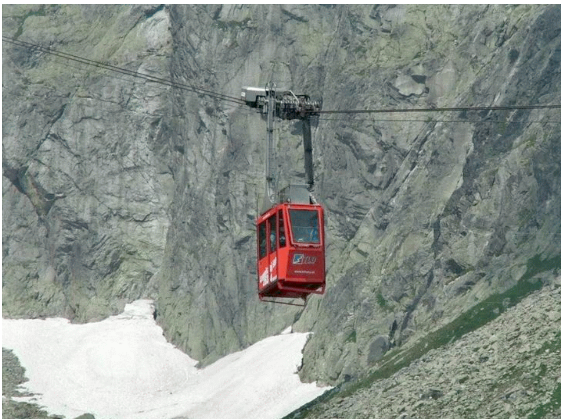
KABÍNKOVÁ LANOVKA NA LOMNICKÝ ŠTÍT (2 NOSNÉ LANÁ + ŤAŽNÉ LANO)
