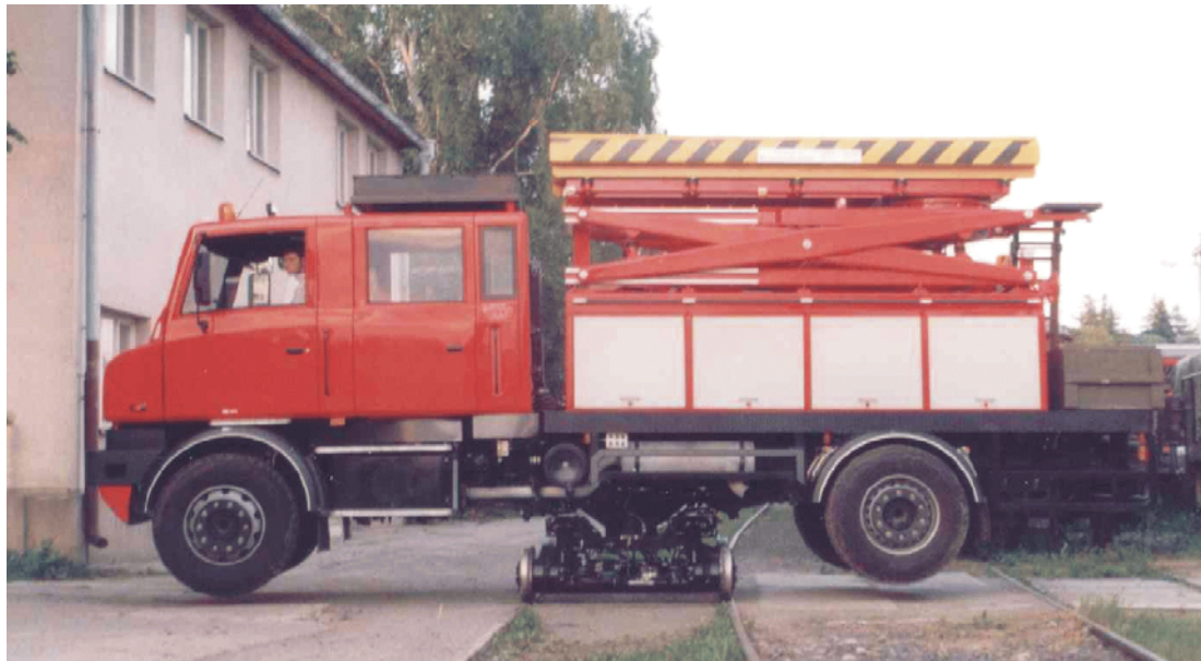
NAKOĽAJOVANIE DVOJCESTNÉHO VOZIDLA SO STREDOVÝM ADAPTÉROM
