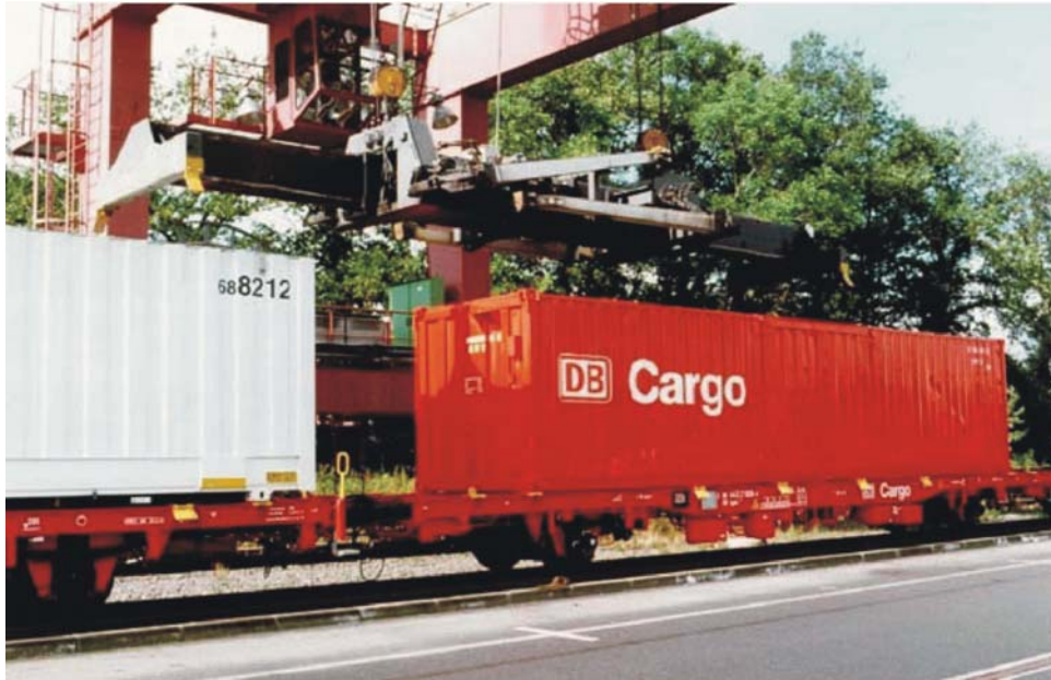
KONTAJNER NA VAGÓNE A KONTAJNEROVÝ ŽERIAV SO SPREADEROM
