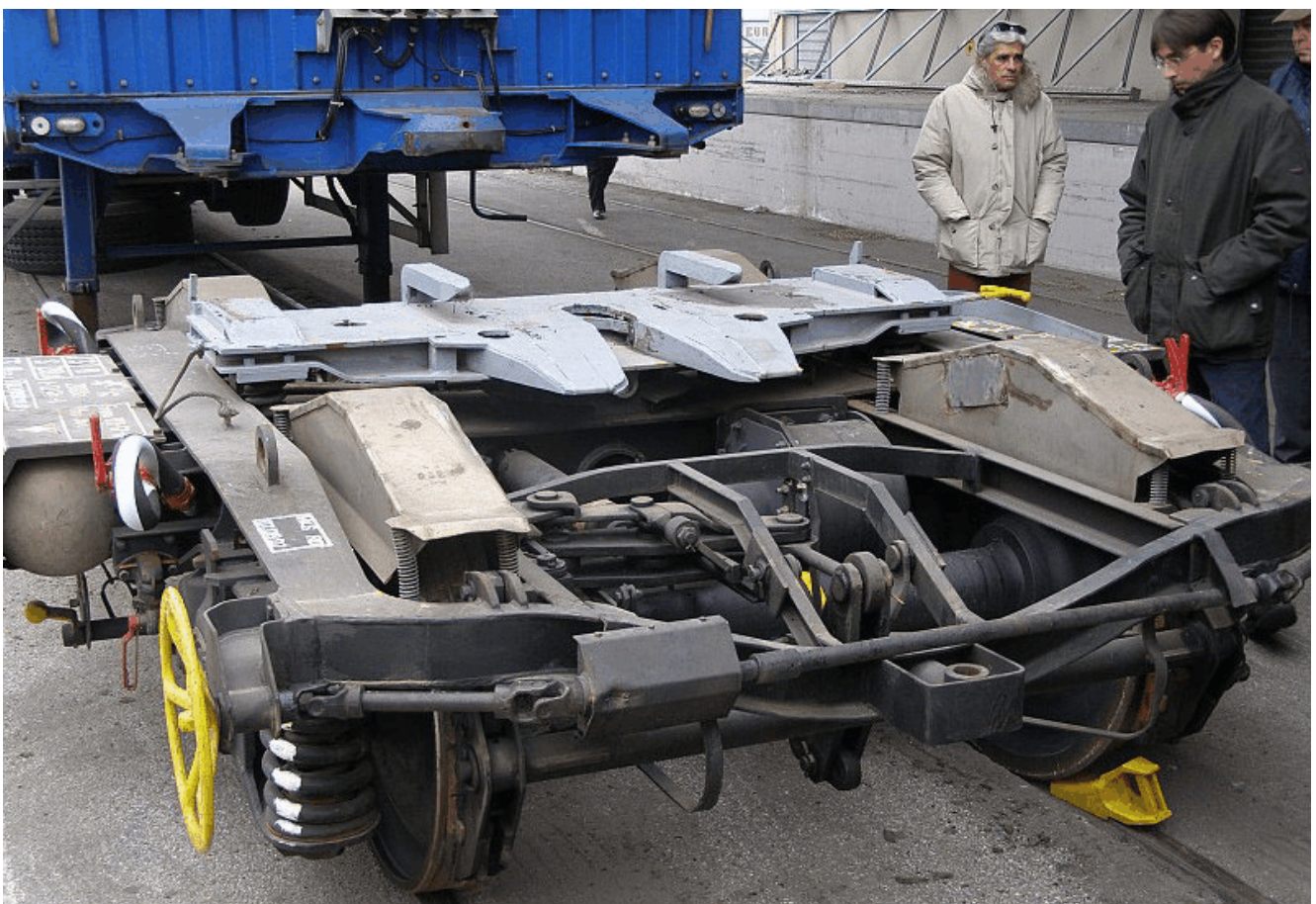
STREDOVÝ PODVOZOK S ADAPTÉROM PRE PREDNÝ KONIEC NÁVESU (Breda Carro Bimodale)
