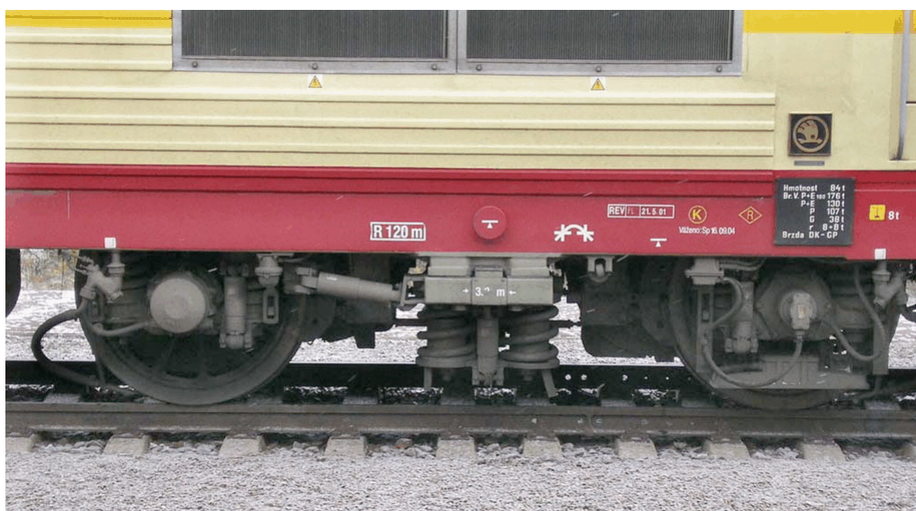
PODVOZOK EL. RUŠŇOV ŠKODA 2. GENERÁCIE (Doplnený tlmič vlnivého pohybu)
