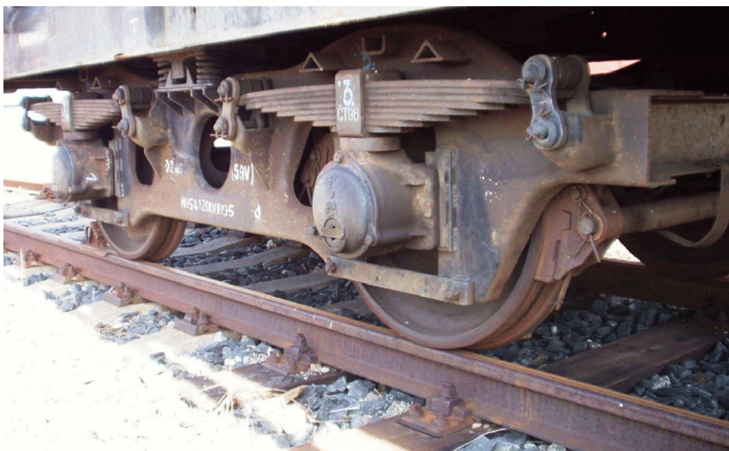
“STREDOEURÓPSKY” NÁKLADNÝ PODVOZOK TYP 26-2.8 S ODPRUŽENÝMI KLZNICAMI
