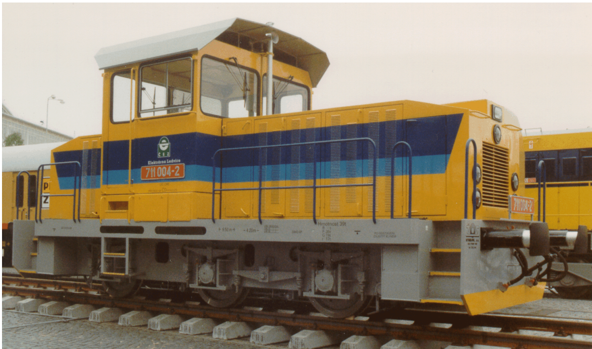
POJAZD 3-OJ NÁPRAVOVÉHO RUŠŇA S PREVAHADLOVANÍM 2 NÁPRAV
