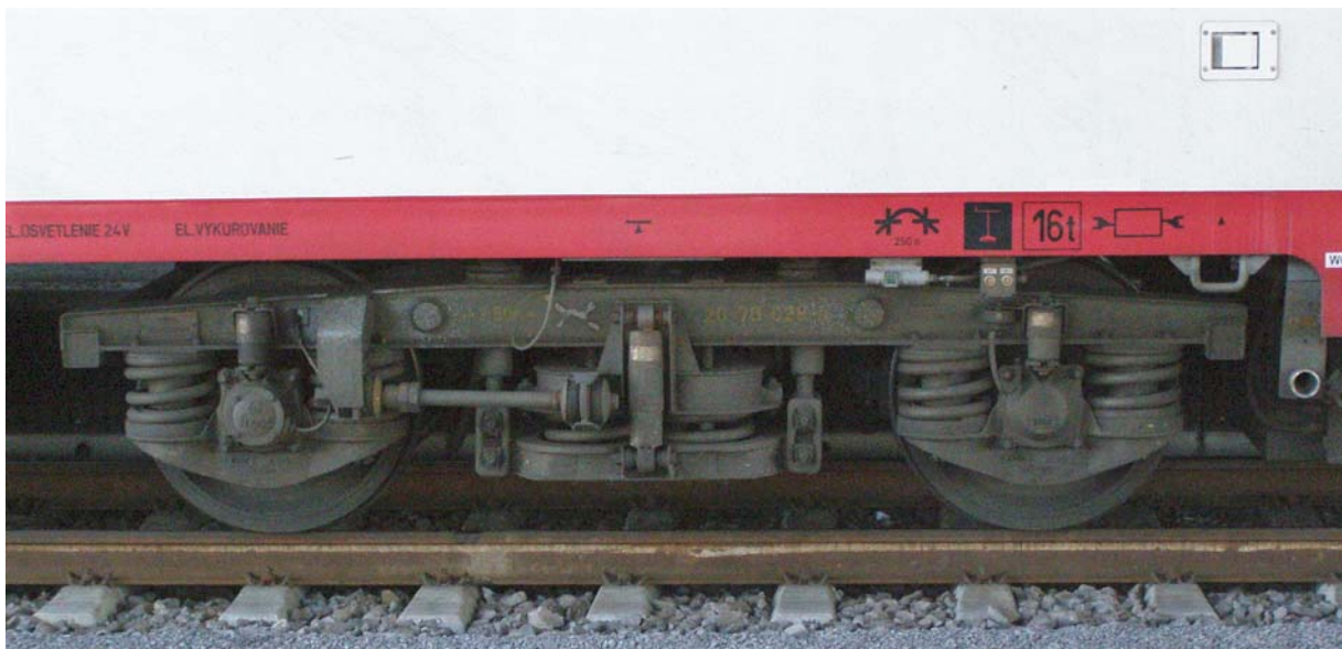
PODVOZOK GÖRLITZ Vk (s kotúčovou brzdou)
