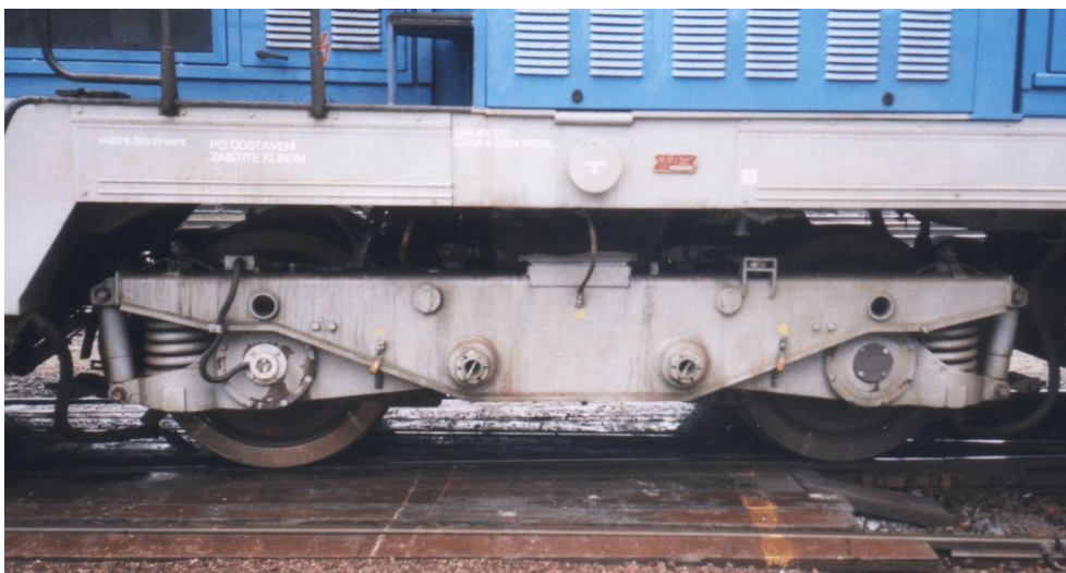
PODVOZOK DE RUŠŇOV R. 735, 736 S ULOŽENÍM SKRINE NA KLZNICIACH (TEES Martin n. p.)
